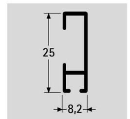
Pour un accrochage optimal, fixer au mur un clip à 2 cm de chaque extrémité du rail et ensuite à environ tous les 60 cm. Lorsque tous les clips sont vissés, bien horizontalement, vous présentez le rail et vous le cliquez en frappant avec le poing.
